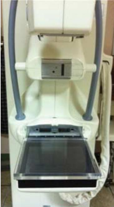
그림 47. Face shield, compression paddle, bucky를 제거하고 아크릴 블록을 올린 모습
