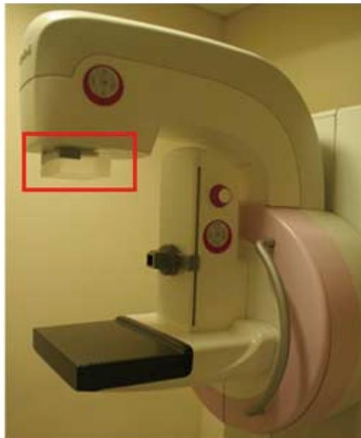
그림 52. Face shield와 압박대를 제거하고, Face shield 곁이에 PMMA 팬텀을 삽입함
