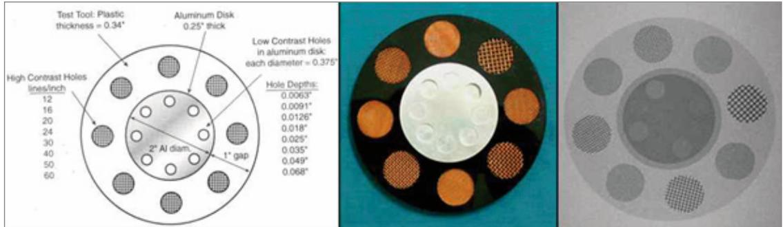
그림 37. 투시장치의표준팬텀 CDRH 07-649의 모식도(좌), 실제사진(가운데), 표준팬텀영상사진(우)
