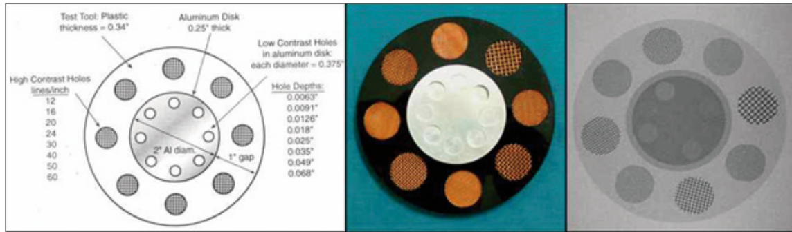
그림 39. CDRH phantom(Center for Devices and Radiological Health phantom, model 07-649)
